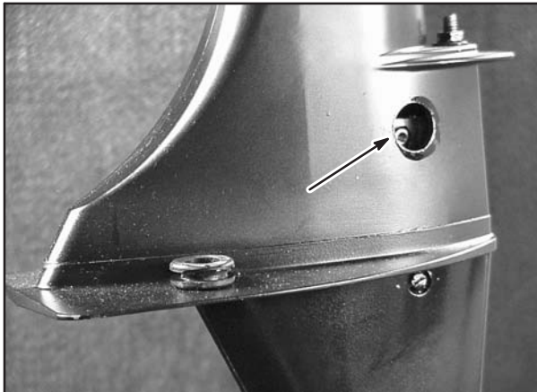
Fig. 143 – Tighten Shift Clamp
